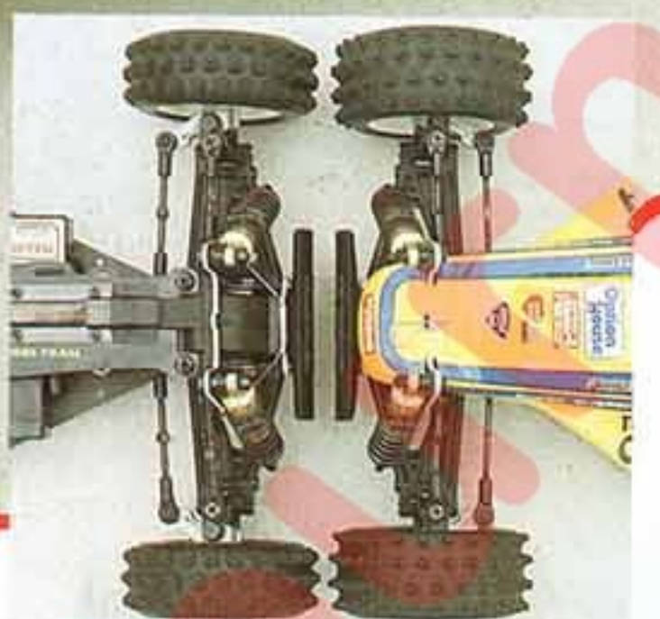
↑ナローフロントタイヤの採用で、ワイドトレッド化をはかっている。
