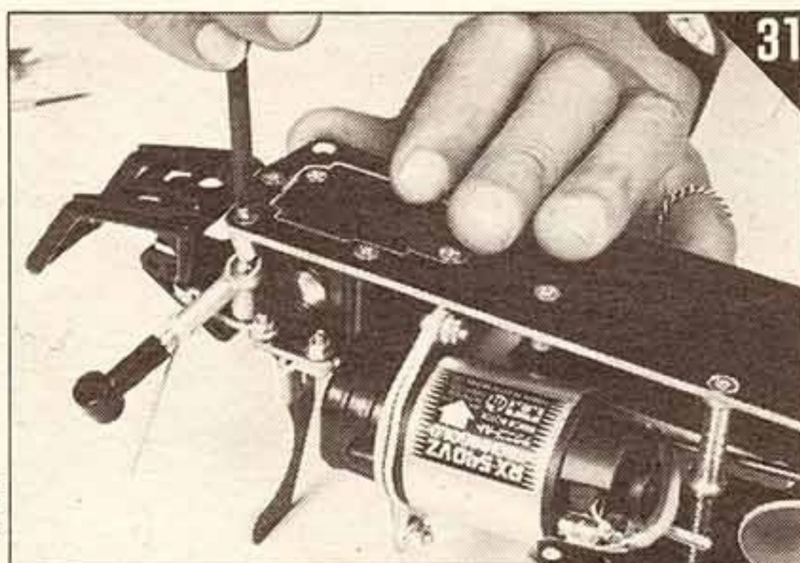
↑リヤサスアームに金属ボールエンドをセットする。一度いっぱいまでしめ込んでから戻して位置を合わせる。
