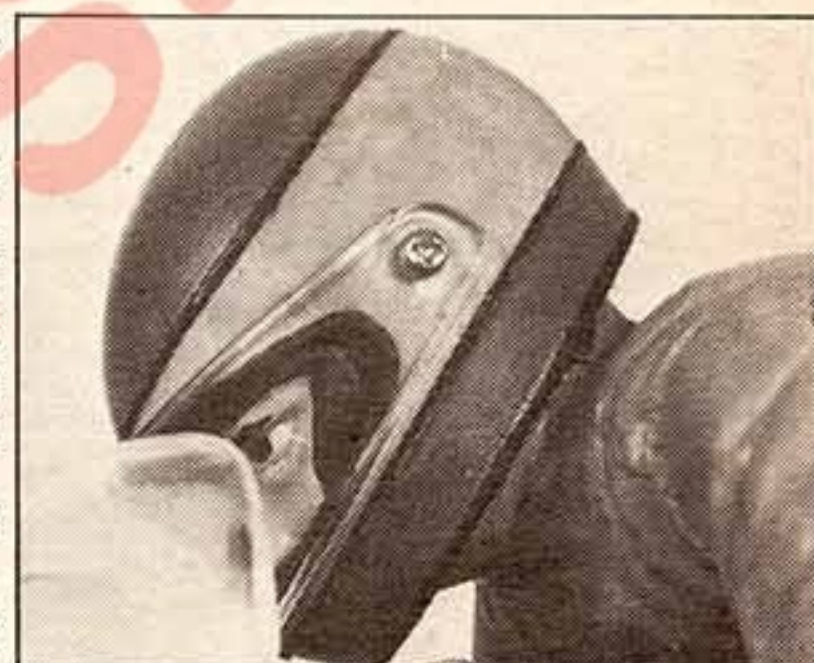
→シールドをビスで固定する。これで開閉もでき、落ちなくなった。
