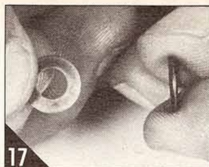
17 ↑皿型のスラストワッシャー5枚を1 枚ずつたがいがいかにセットして、シ ャフトにはめ込む。
