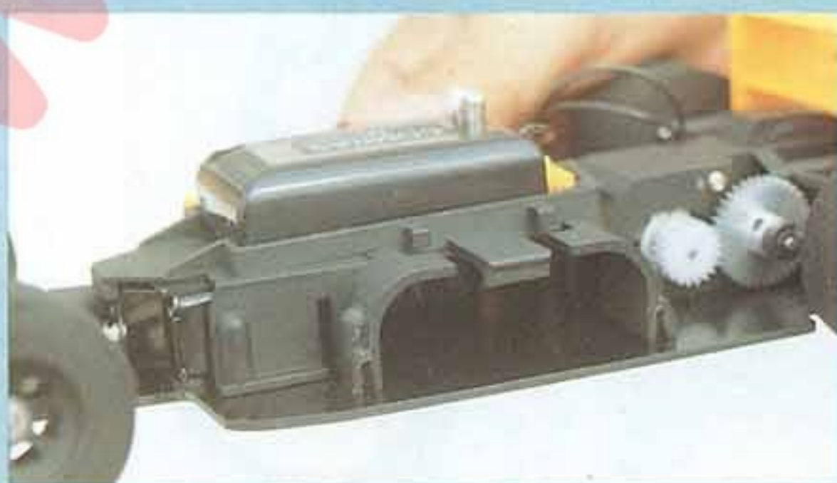
↑バッテリーは新タイプの7.2V270mAhで、ワンタッチで脱着できる。
