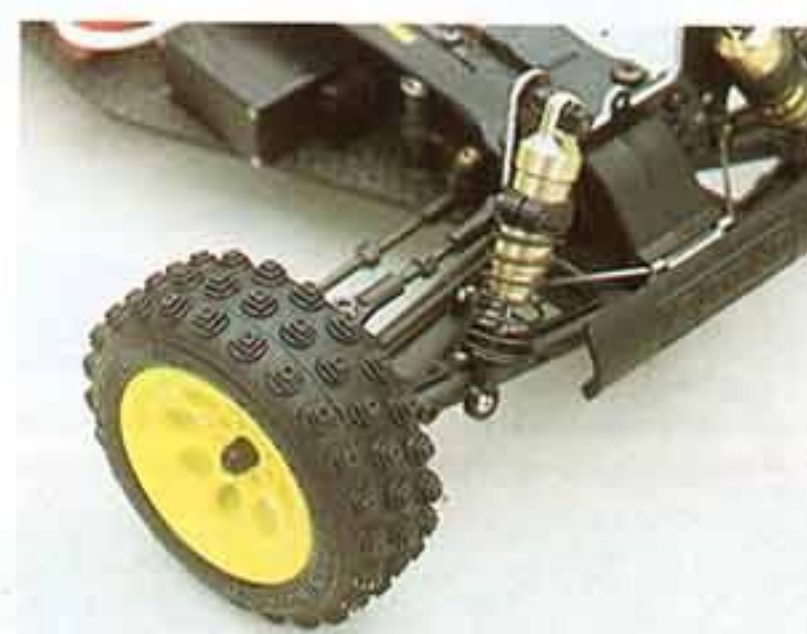
↑フロントタイヤはナロータイプが標準。ピンバイクとハード路面用が付く。
