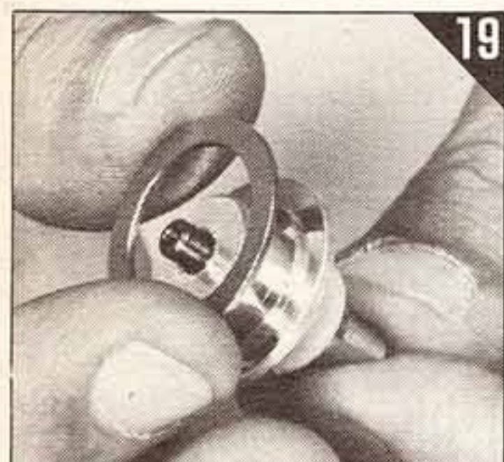
19 ↑17mmスラストワッシャーをプレッ シャープレートにセットする。カドの丸 い方を表にする。
