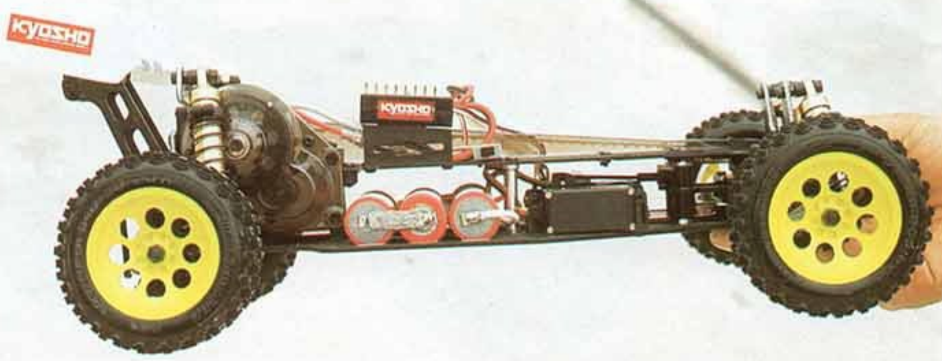
↑フロントタイヤはナロータイプが標準。ピンバイクとハード路面用が付く。
